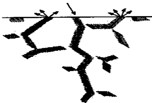
Figure. II-3 : Représentation schématique d'une cascade de collisions
