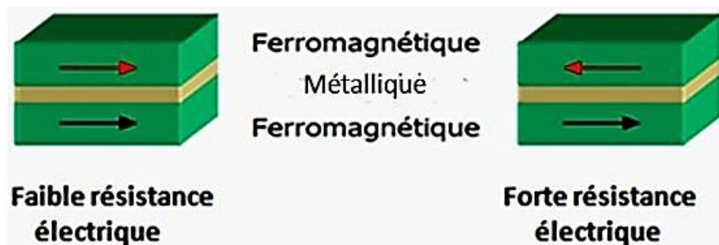
Figure I.6 : les deux états, parallèle et antiparallèle, dans une jonction géant magnétique
