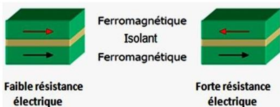
Figure I.7: les deux états, parallèle et antiparallèle, dans une jonction tunnel magnétique.
