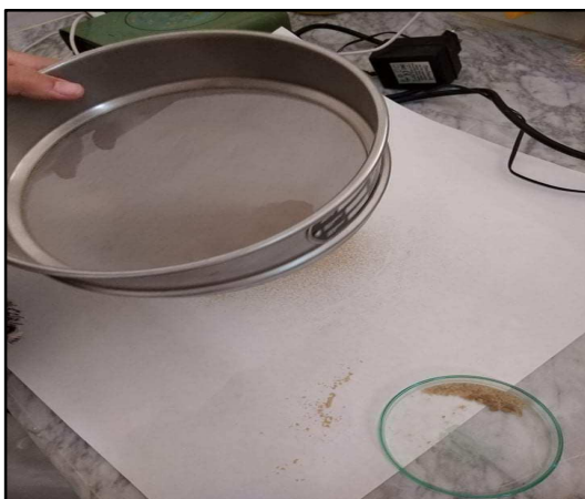
Figure II-5 : Tamisage de la bentonite
