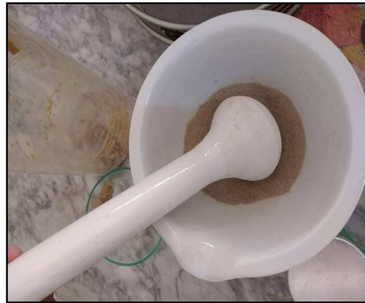
FigureII -4 : broyage de la bentonite récupérée
