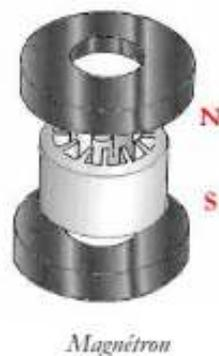
**Figure 02** : Schéma d'un magnétron (N : nord de magnétron (anode), S : sud de magnétron (cathode)) [14]
