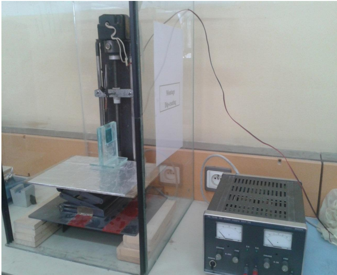
Figure III.4: Dispositif de dépôt des couches minces par dip-coating réalisé au sein du laboratoire Génie Physique –Tiaret.
