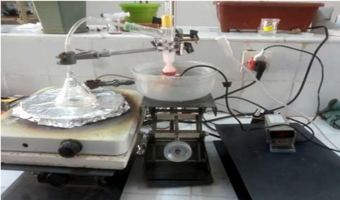
**Figure III.2:** *Photo prise au laboratoire - Technique Spray pyrolyse ultrasonique.*
