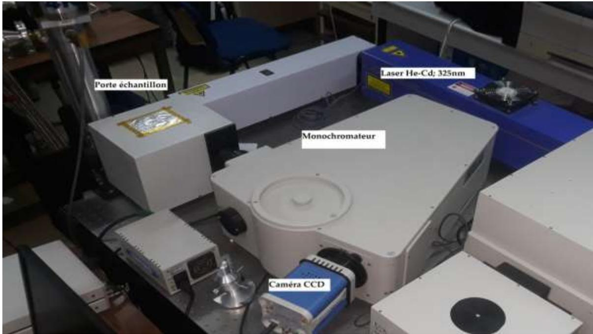
**Figure II.6.** Spectromètre photoluminescence HORIBA –He-Cd 325nm-LABMAT
