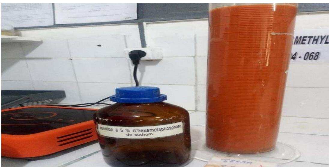
**Figure.IV.7:** Dispositif de l'essai de sédimentométrie
