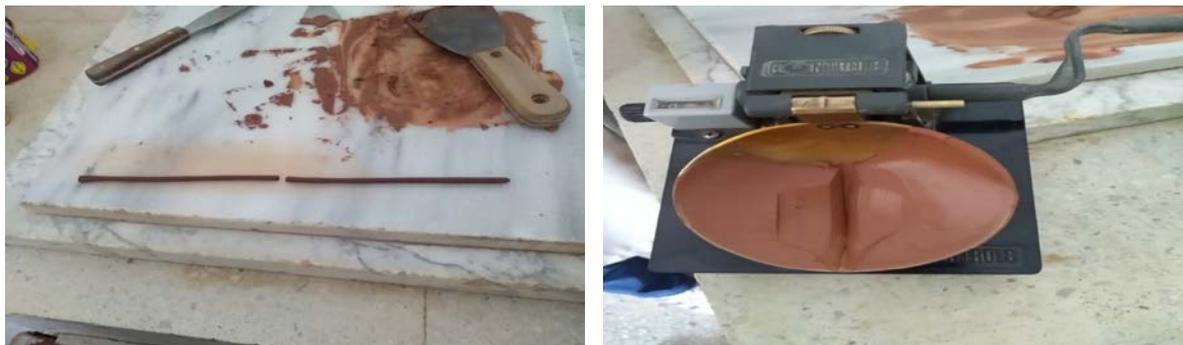
**Figure.IV.4:** Détermination des limites d'Atterberg
