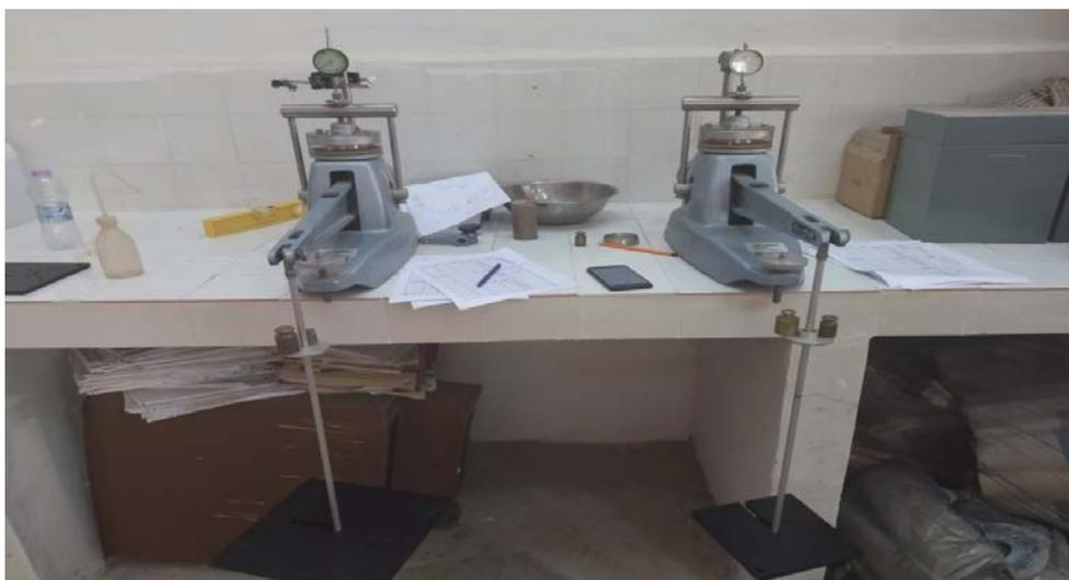
**Figure.IV.30:** Dispositif de l'essai Œdométrique
