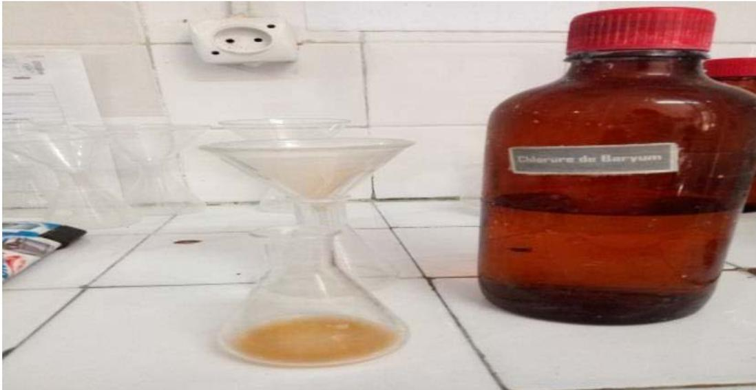
**Figure.IV.10:** Dispositif d'essai de la teneur en sulfates
