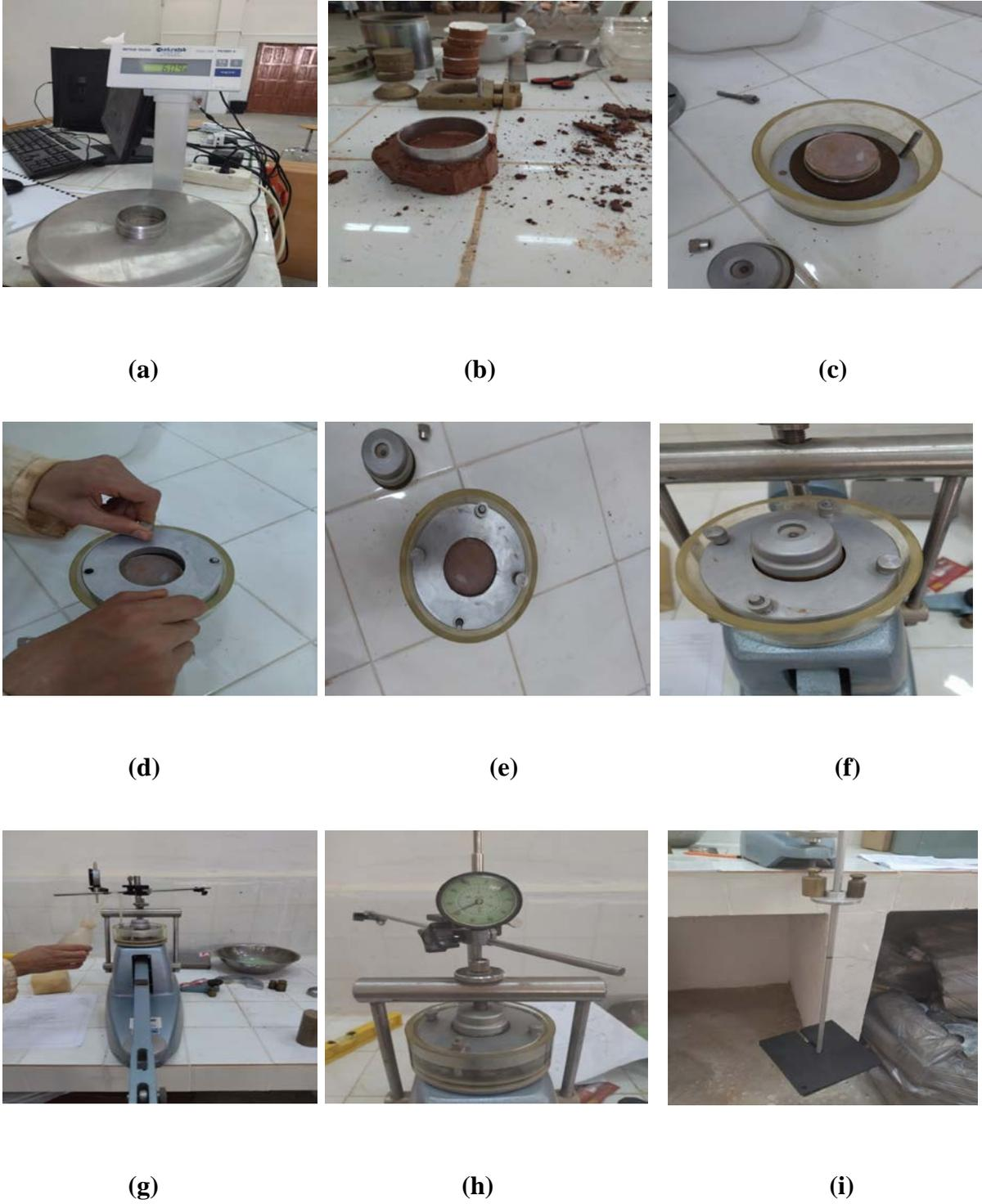
Figure IV.31 : les étapes de l'essai Cedométrique
