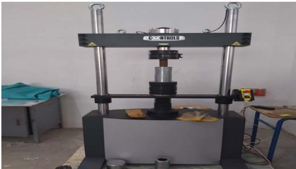
**Figure.IV.36:** Presse utilisée pour l'essai de compression
