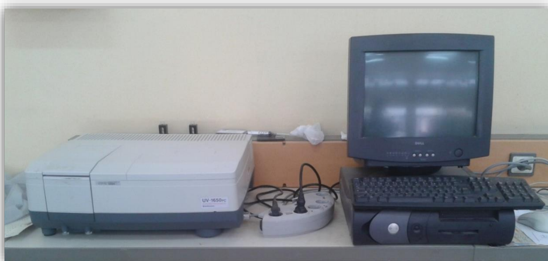
Figure III 9 : Schéma de photomètre à double faisceau de type SHIMADZU (UV 1650 PC).
