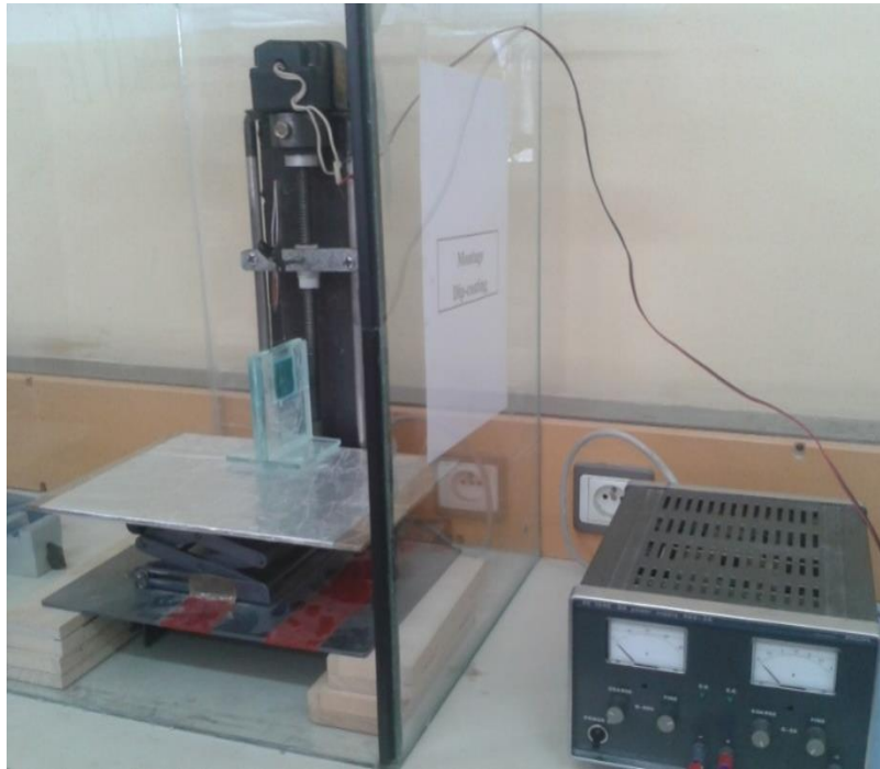
Figure III 3: Dispositif expérimental de trempage – tirage (dip-coating).
