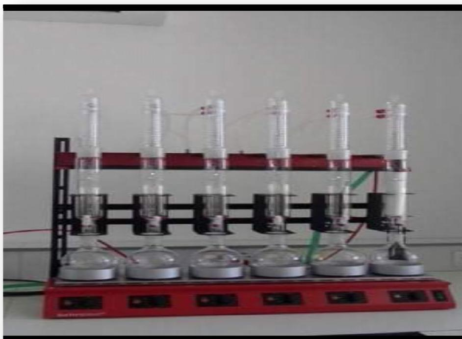
Figure I .3 : Extraction des lipides au soxhlet (*photo originale*)
