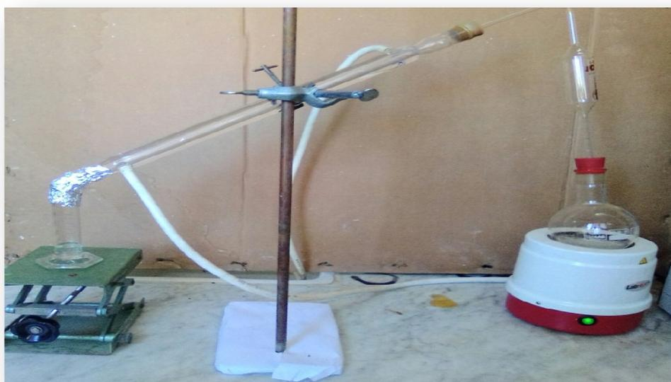
Figure I. 4 : Le montage d'entraînement à la vapeur (*Photo originale*)
