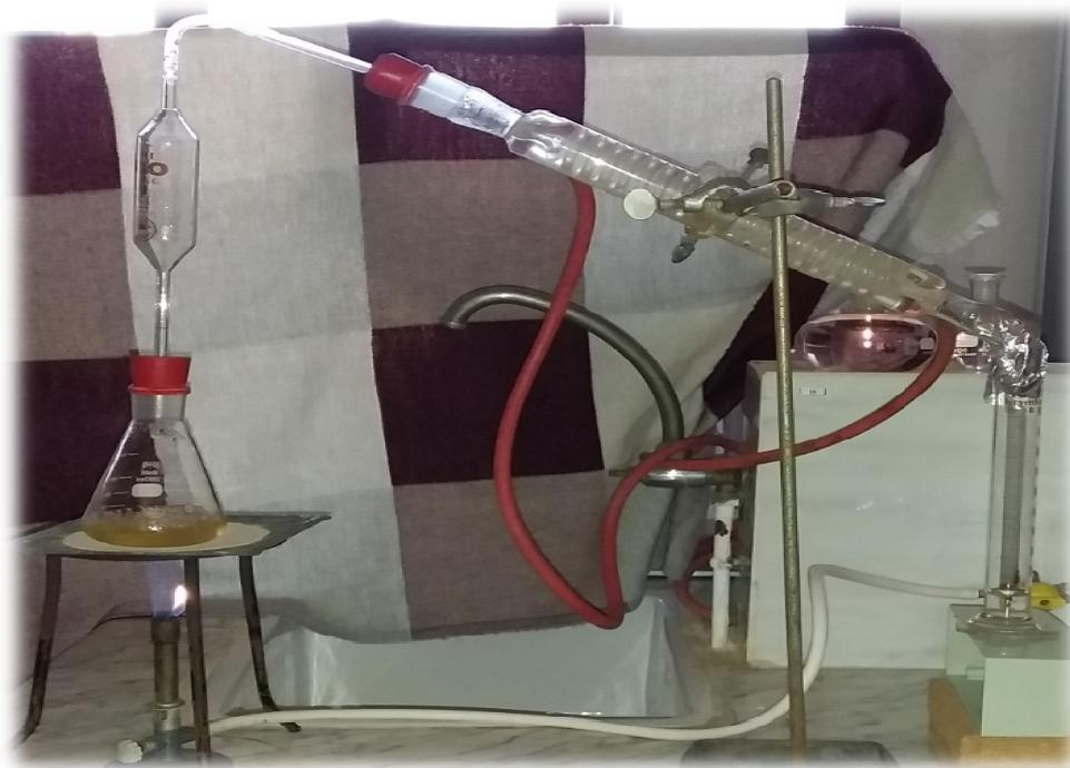
**Figure I. 2** : Le montage d'entraînement à la vapeur (*Photo originale*)
