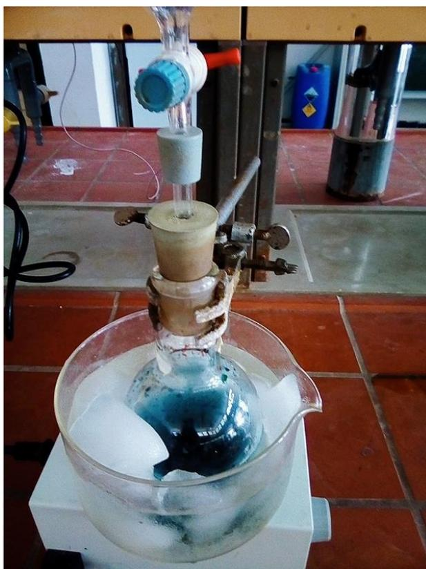
**Figure 01 :** Montage réactionnel de la synthèse de la polyaniline
