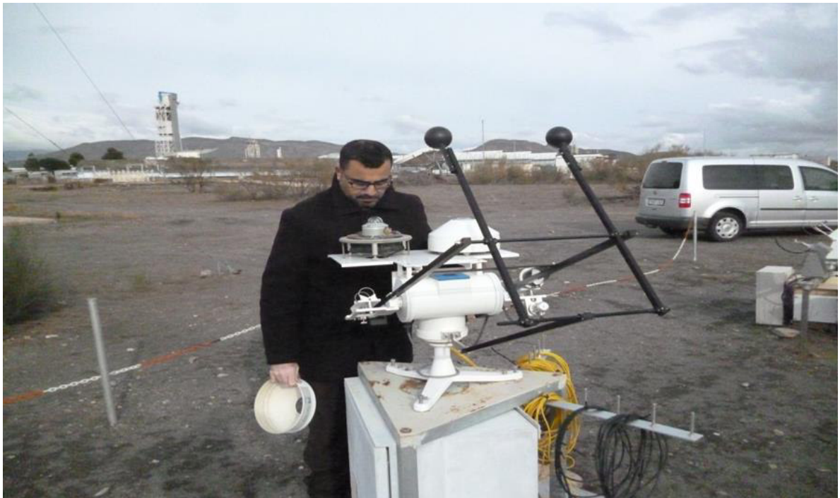
Figure 3-11 : Inspection visuelle des radiomètres (photo prise au PSA-Plateforme Solaire d'Almeria-Espagne)
