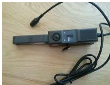
Figure.IV.5 Photo capteur de mesure de courant
