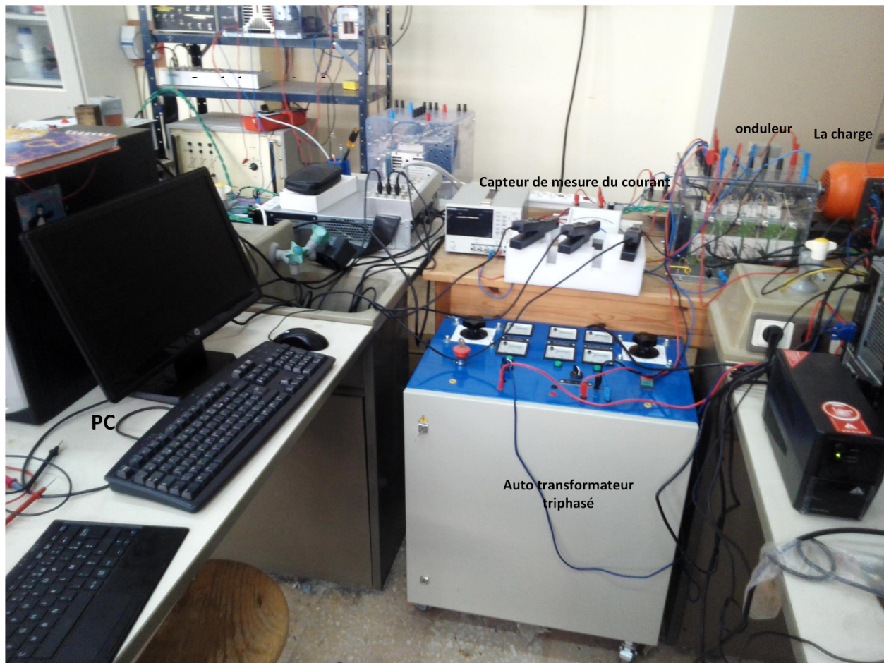
Figure.IV.1 Photo du banc d'essai
