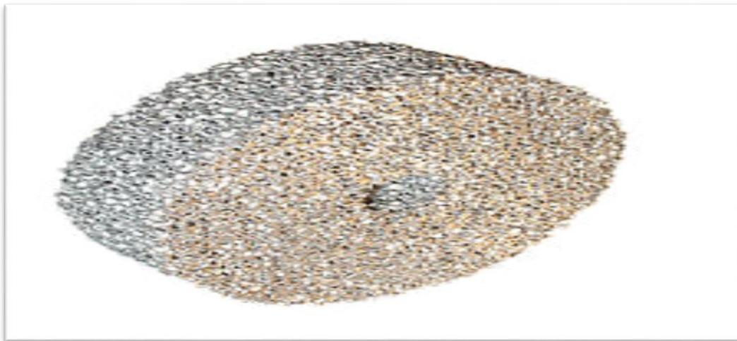
**Figure I-8: pièce obtenue par frittage**
