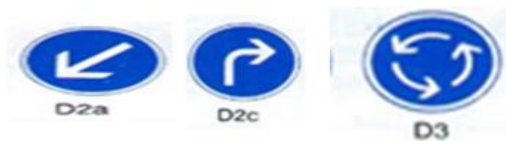
Figure VII.16 : -Panneaux de signalisation d'obligation (type D)
