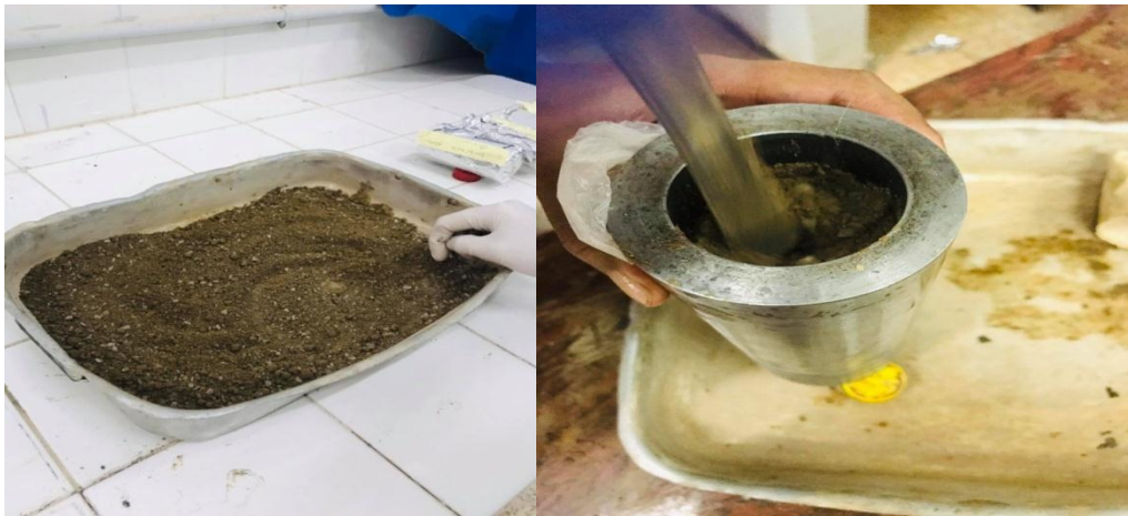
Figure IV.15 la mise en place de l'échantillon dans le moule
