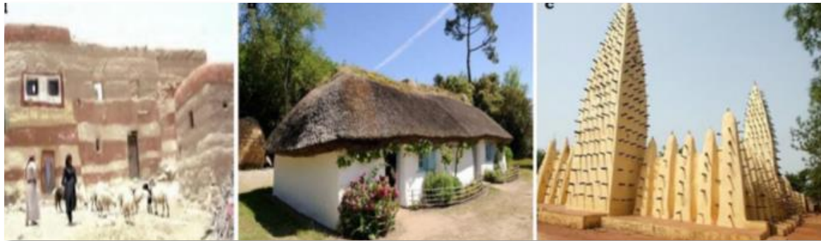
Figure I. 9: construction en terre empilée: (a) maison à sadah Yémen, (b) Bourrine de Vendée; (c) mosquée deBoboDioulasso
