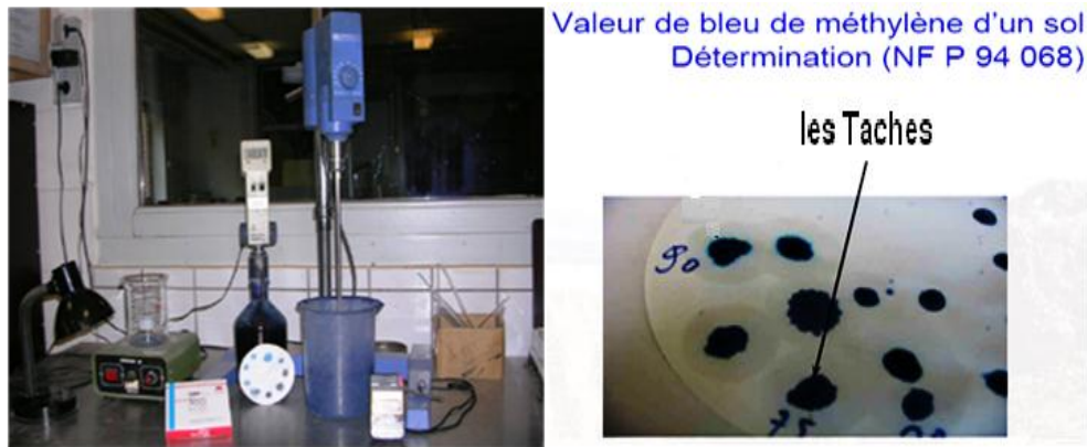
Figure IV.7 Mise en œuvre de l'essai au bleu de méthylène et Test de la tache
