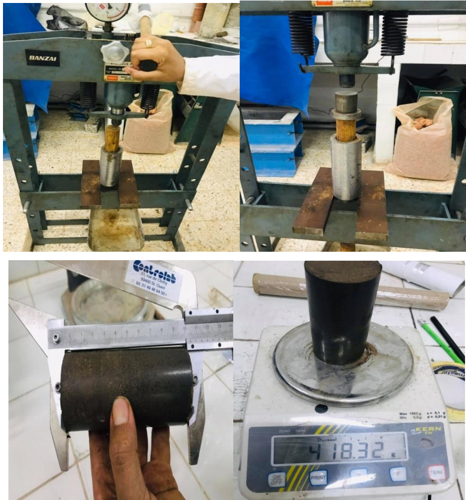
Figure IV.17 démoulage de l'éprouvette
