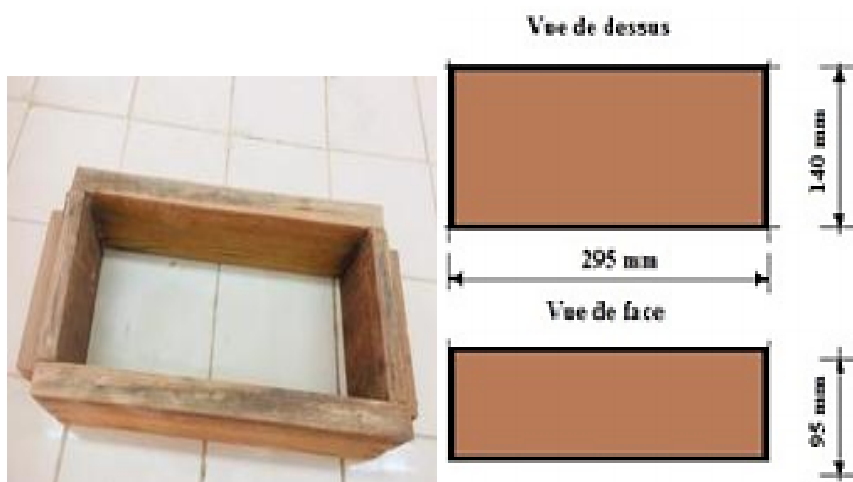
Figure IV. 31 Le moule d'adobe 295x14x95 mm
