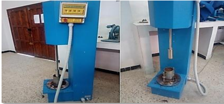
Figure IV.10 Appareillage pour l'essai Proctor
