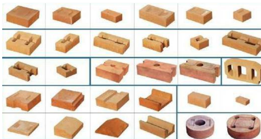
Figure I.13 : Différents produits de blocs de terre comprimée
