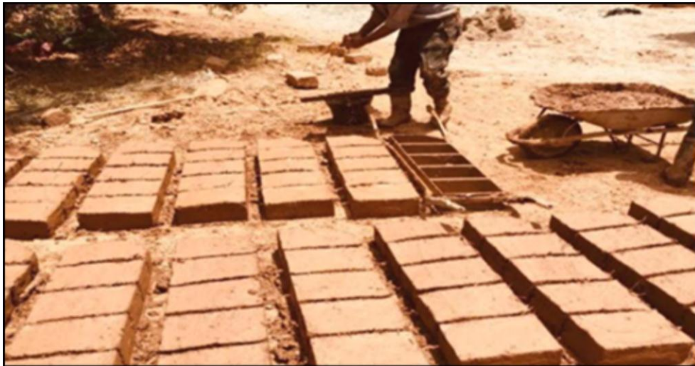
Figure I.2 : Moulage et séchage des blocs adobes [33]
