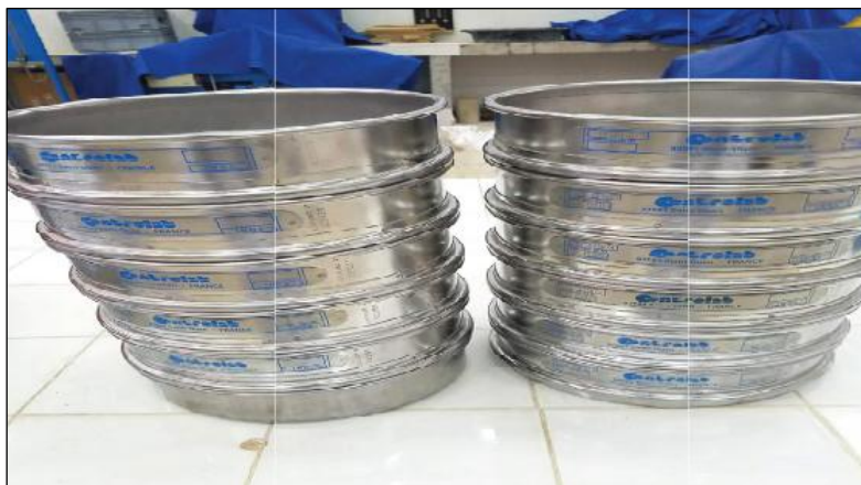
Figure IV.2 Colonne de tamis au tamis de 80\mu\text{m}
