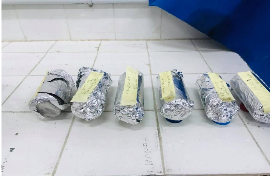
Figure IV.19: l'éprouvette pour l'essai à la résistance à la compression
