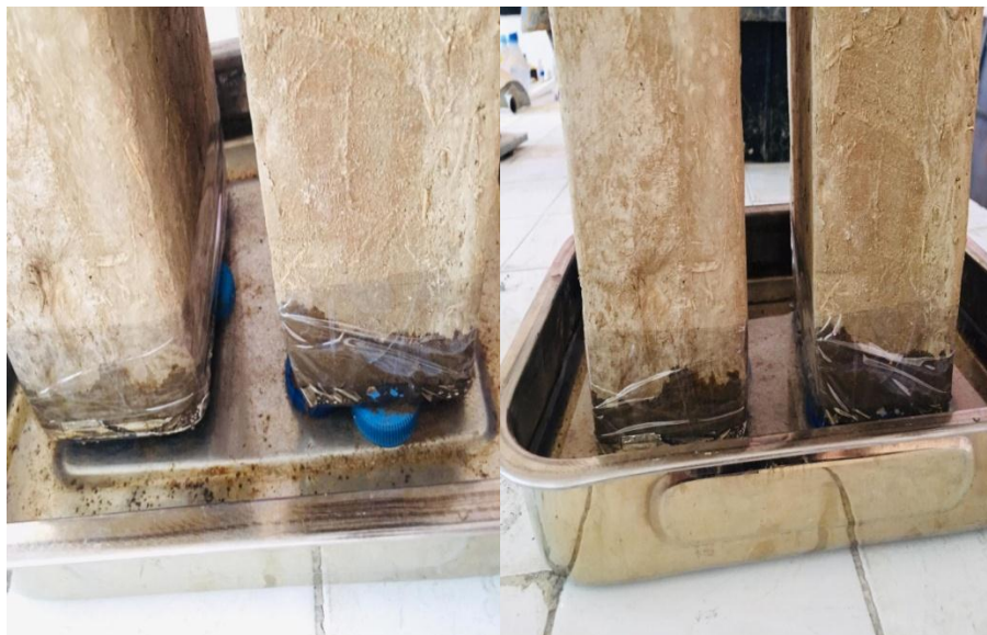
Figure IV. 34: Schéma du dispositif de l'essai d'absorption
