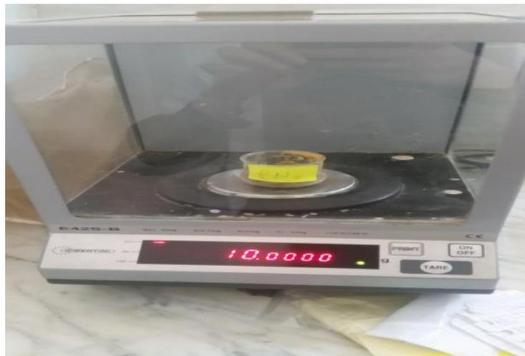
**Figure 10** : Mesure de l'humidité du sol
