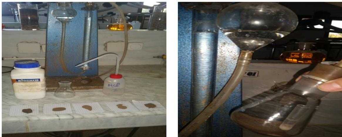
**Figure 13** : Détermination du calcaire total.
