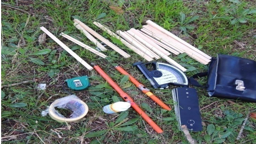
Figure N° 07 : Matériel utilisé pour les mesures dendrométriques et le carottage des arbres (photos : Arab A, 2020).
