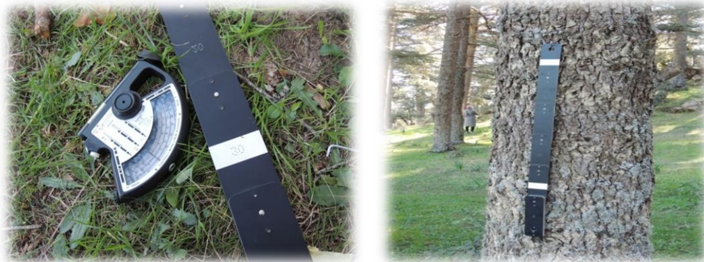
Figure N° 08 : Mesure de la hauteur totale par le dendromètre Blume-Leiss (photos : Arab A, 2020).
