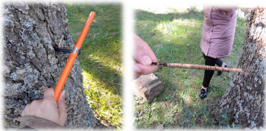
Figure N° 11 : Carottage des arbres par tarière de Pressler (photos : Arab A, 2020).
