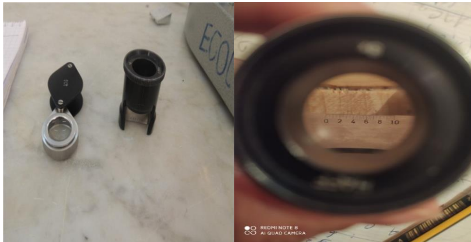
Figure N° 17 : Mesure de la largeur des cernes par une loupe graduée (photos : Arab A, 2020).
