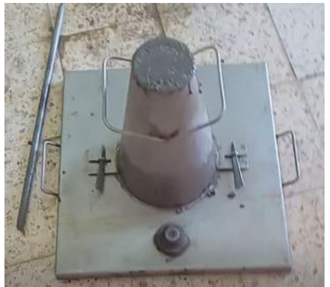
Figure (III. 14) Essais de consistance au cône d'Abrams
