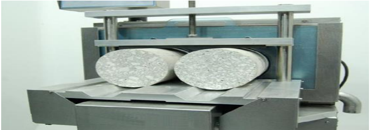
Figure (III. 17) rectifieuse des surfaces des éprouvettes cylindriques de béton
