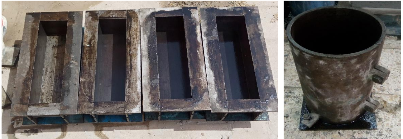
Figure (III. 11) Éprouvettes prismatiques (10x10x40)cm et cylindre (16x32)cm
