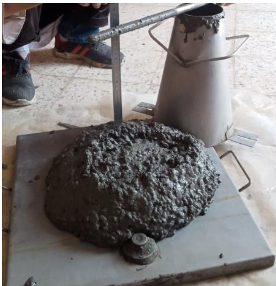
Figure (III. 14) Essais de consistance au cône d'Abrams
