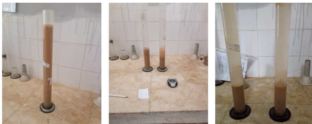
Figure (III. 3) Éprouvette de mesure pour l'essai d'équivalent de sable
