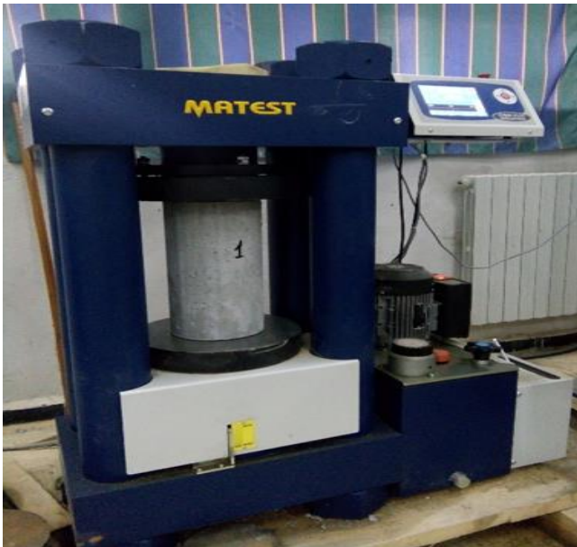
Figure (III. 21) Chargement des éprouvettes cylindriques
