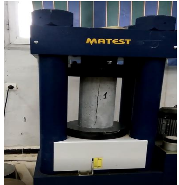
Figure (III. 22) Rupture des éprouvettes cylindriques
