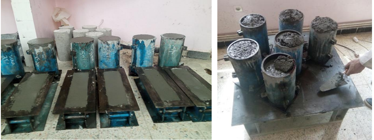
Figure (III. 15) Coulage et vibration du béton des éprouvettes cylindriques et prismatiques
