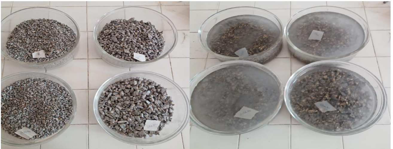
Figure (III. 5) Préparation des échantillons pour la détermination du coefficient d'absorption et la propreté superficielle
