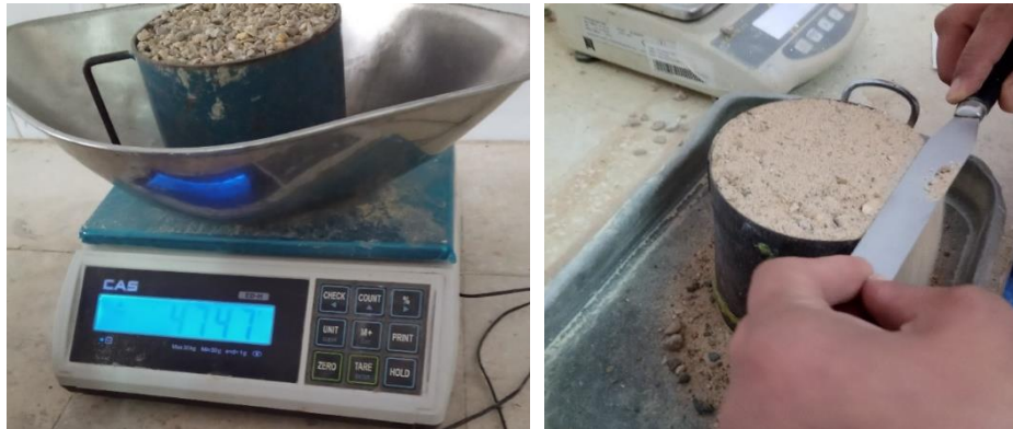
Figure (III. 4) Détermination des masses volumiques des granulats
