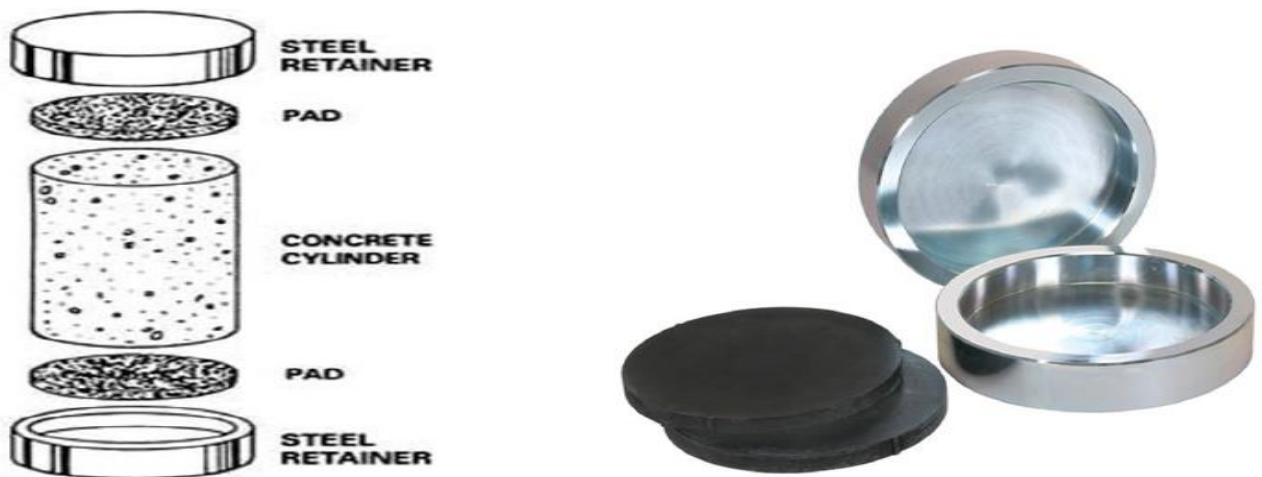
Figure (III. 20) Les plaque de compression des éprouvettes cylindriques de béton
