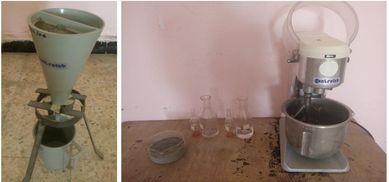
Figure (III. 12) Procédé de détermination de la dose de saturation par le cône de March
