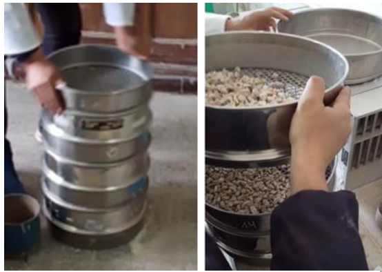
Figure (III. 2) Analyse granulométrique des granulats
