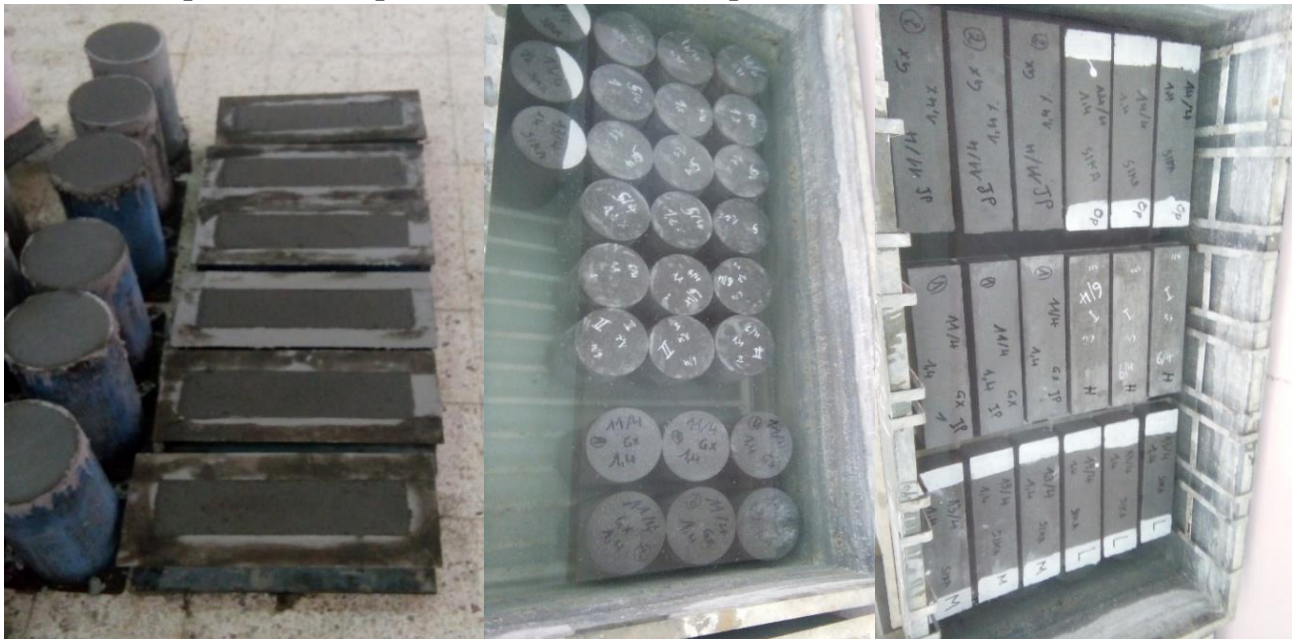
Figure (III. 16) Mode de conservation des éprouvettes cylindriques et prismatiques
