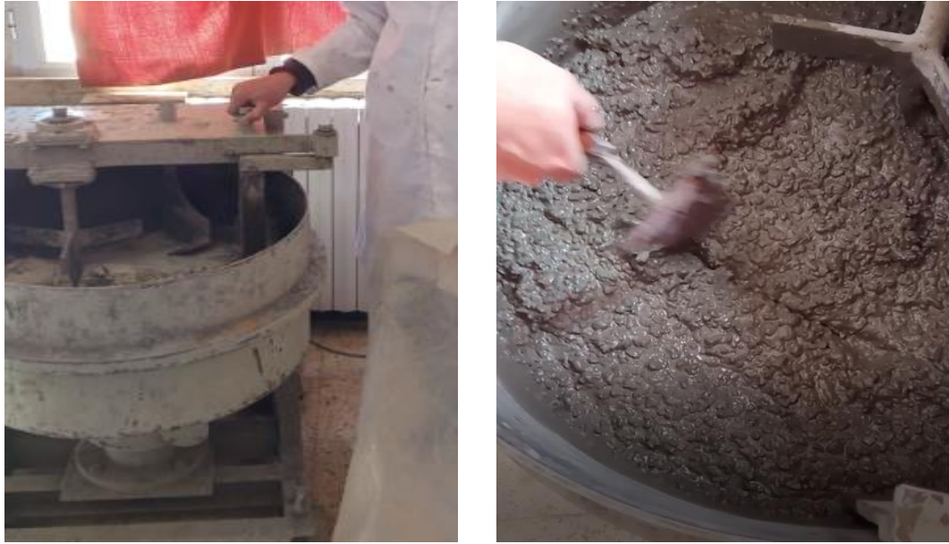
Figure (II. 19) Malaxage des différents constituants de béton
