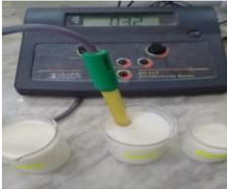
**Figure N°08: détermination de la conductivité électrique.**
