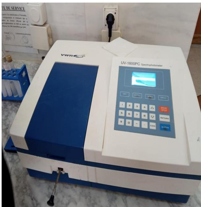
**Figure 5.** Spectrophotomètre pour dosage des protéines par méthode de Biuret utilisé pour mesurer le taux des protéines de «poudre de lait » (photo originale).
