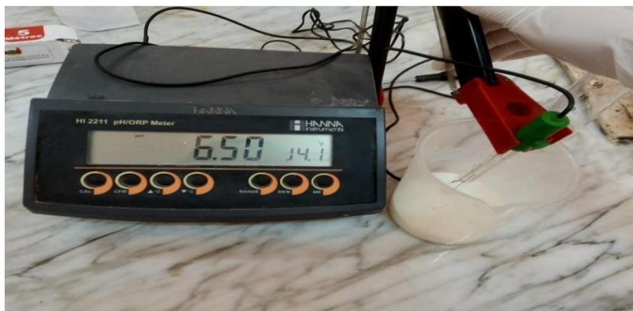
Figure 2.pH-mètre pour mesurer le pH de < poudre de lait > (Photo originale).
