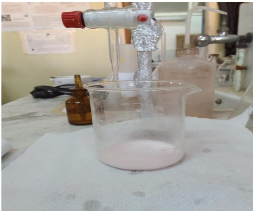
**Figure 3.** Mesure de l'acidité titrable de «poudre de lait » (Photo originale).
