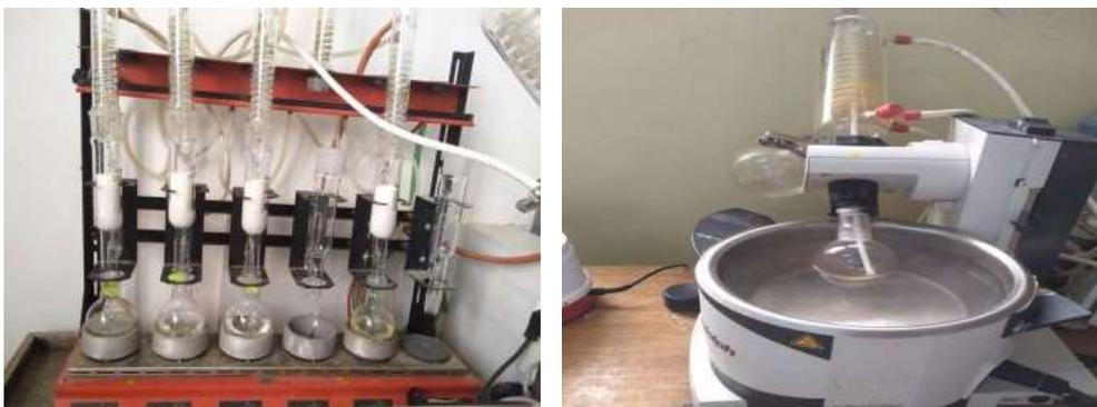
Figure N° 4 : appareil de soxhlet
