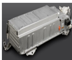
(b) Batterie NiMH de la Toyota Prius
