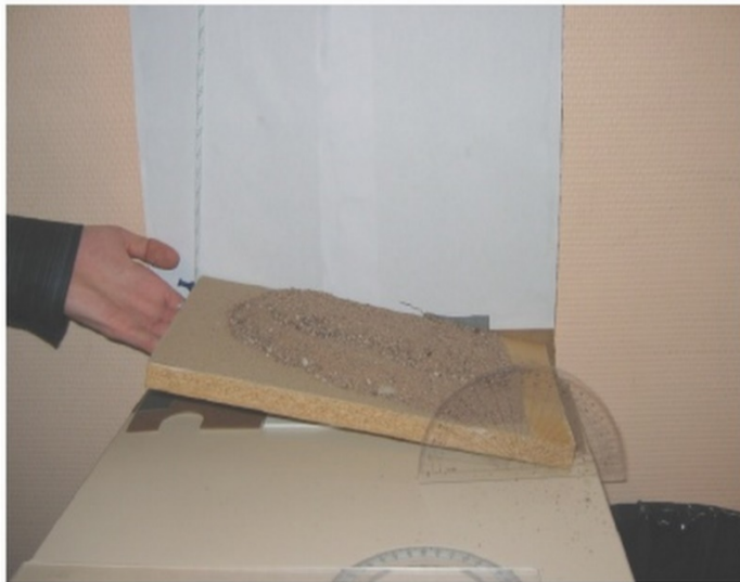
Figure III.14 : dispositif de mesure de l'angle de glissement Compression uni axiale
