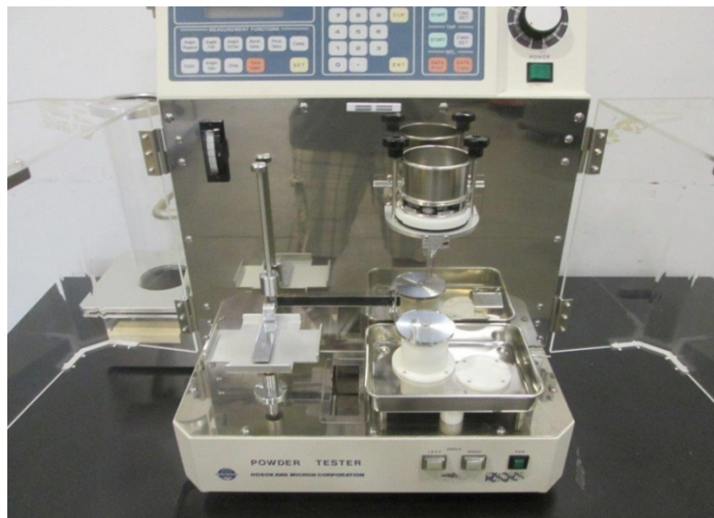
(b) : Tassement automatique.[du site www.sllc.com/hosokawa-micron-pt-powder-tester ]
