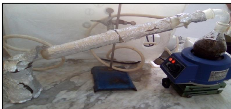
**Figure 4:** Montage d'hydrodistillation
