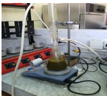
Figure B5 : Chauffage à reflux des extraits
