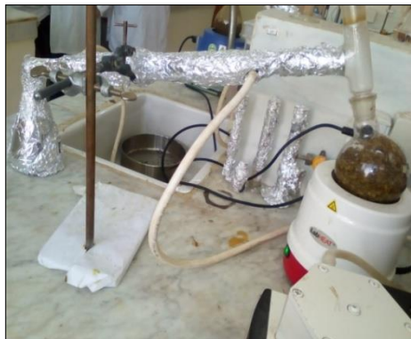
Figure B1 : Montage d'hydro distillation
