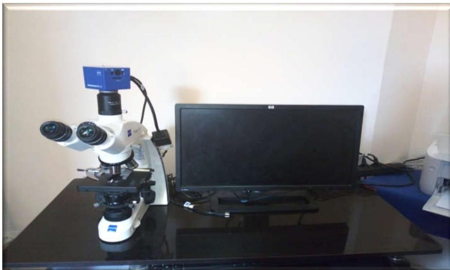
**Figure 9.** Microscope liée à un appareil photo numérique
