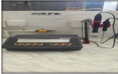
**Photo N°12:** mesure du pH d'un échantillon de sol à l'aide d'un pH mètre.
