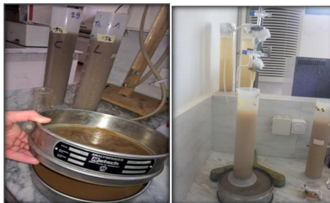
**Photo N° 07:** Analyse granulométrique par la méthode de la pipette de Robinson.
