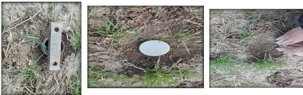
**Photo N° 08:** Mesure de la densité apparente à l'aide de cylindre.
