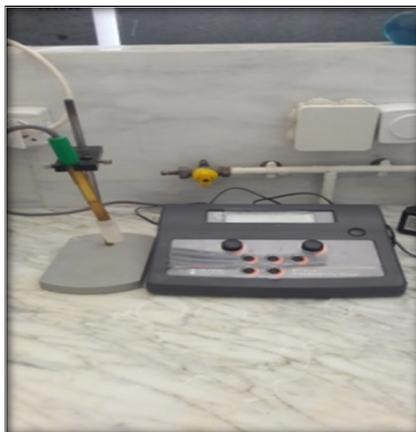
**Photo N°13 :** Mesure de la conductivité électrique du sol par le conductimètre.
