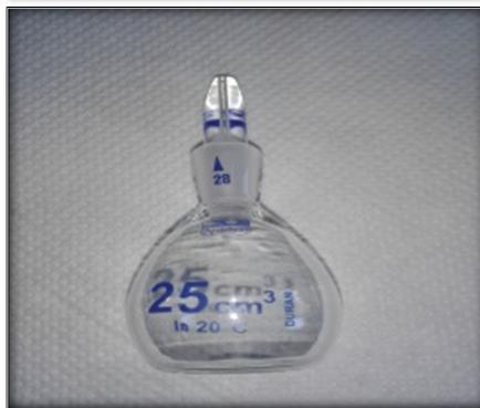
**Photo N° 09:** Mesure de la densité réelle par le pycnomètre.
