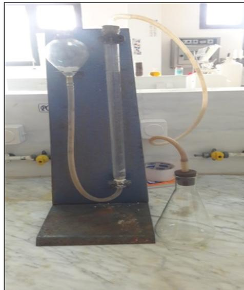
**Photo N°14** : Mesure du calcaire total par le calcimètre de Bernard.
