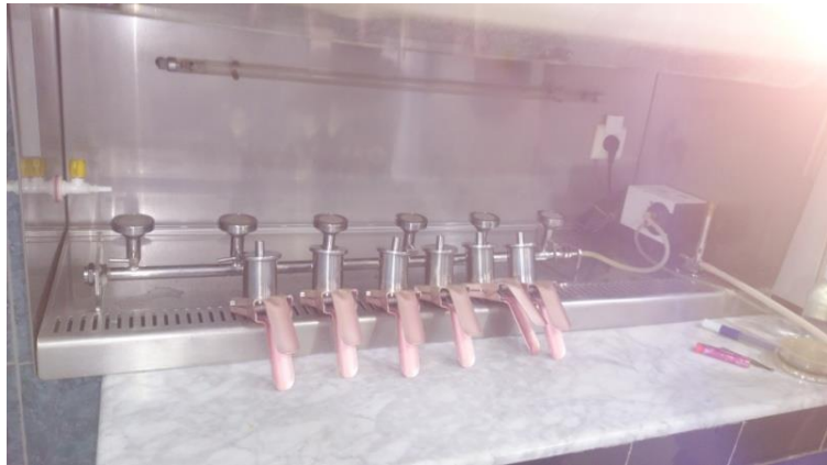
Photos 02 : Hôte bactériologique et la rampe de filtration.
