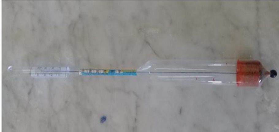
Figure14. Thermo-lacto-densimètre (Photo prise au laboratoire, 2019)
