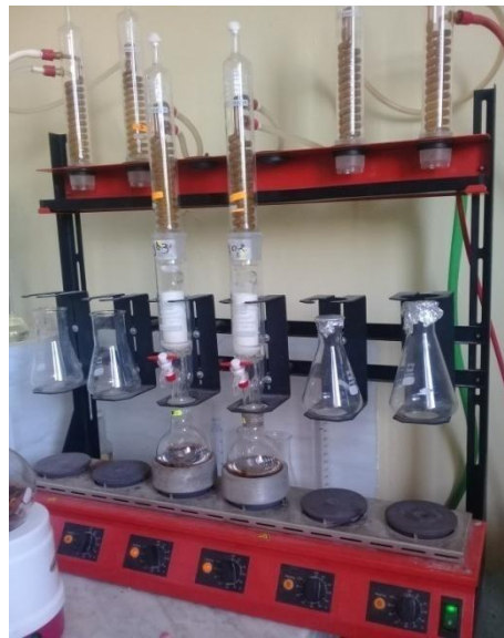
Système chauffage-réfrigération pour l'extraction de MG
