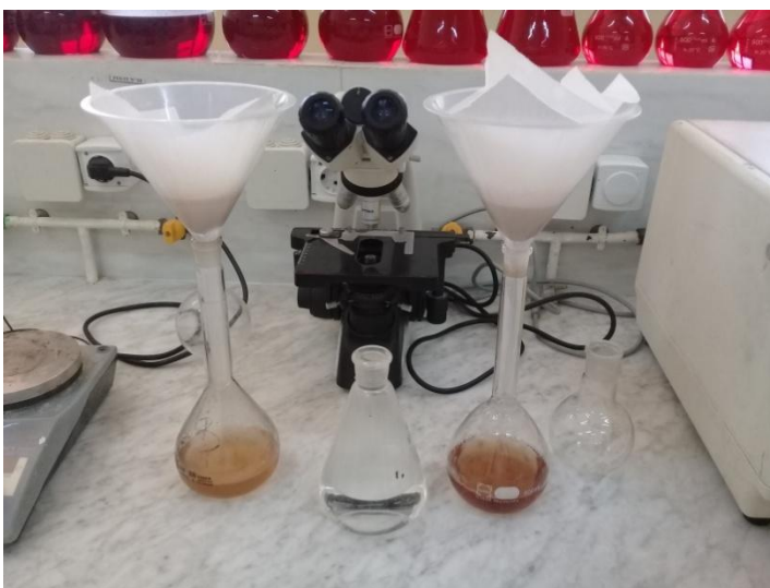
Filtration de la MG
