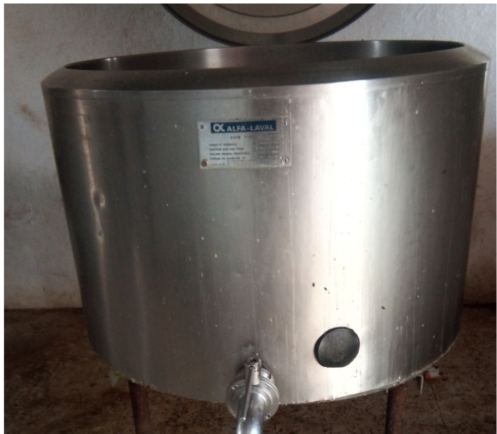
Figure 11 : Machine de refroidissement de lait
