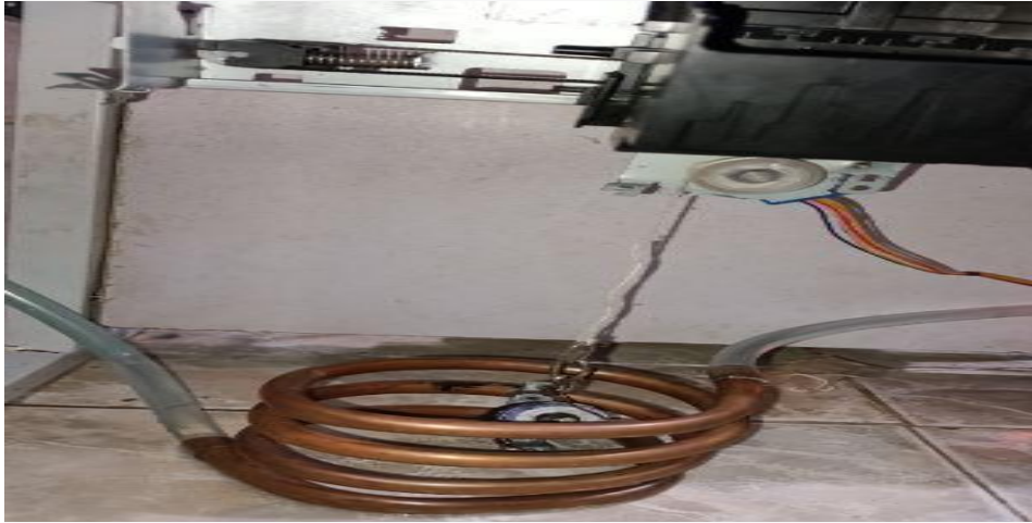
Figure V.14 Pose de l'acier à l'intérieure du four
