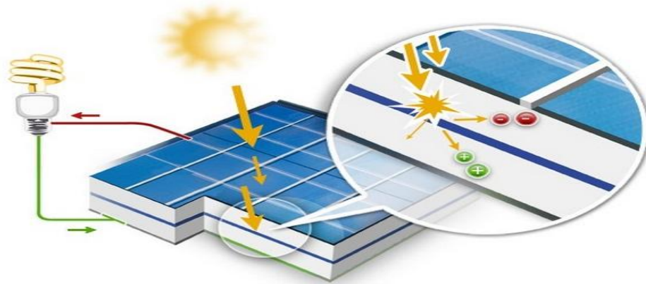
Figure I.8 : Fonctionnement d'une cellule photovoltaïque.
