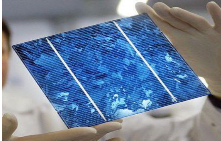
Figure III.7 : Cellule photovoltaïque en silicium polycristallin [61].
