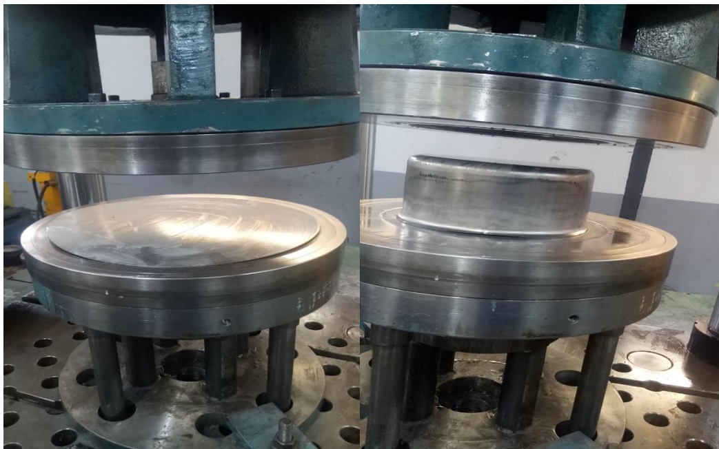
Figure III.10 : Positionnement du flan pour emboutissage.
