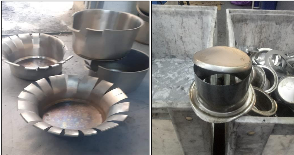
Figure III.3 : Exemple de défauts de l'embouti cible.
