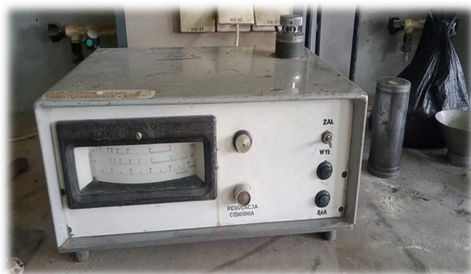
Figure I.9: Appareil de mesure de la perméabilité
