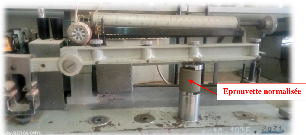
Figure I.11 : Appareil de mesure la résistance au cisaillement
