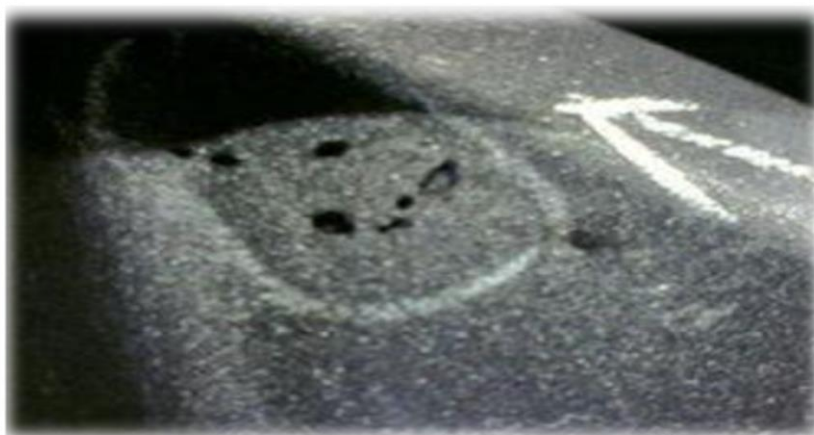
Figure I.18: Défaut de retrait de cavité
