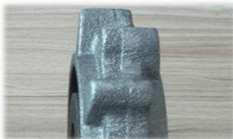
Figure I.20: Défaut de décalage
