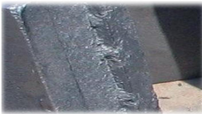
Figure I.21: Défaut de combustion du sable
