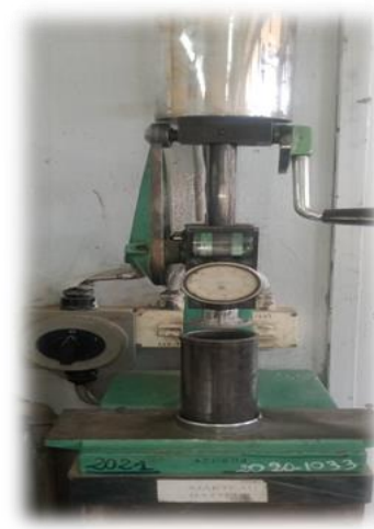
Figure III.4 : Damoir utilisé pour la confection des éprouvettes
