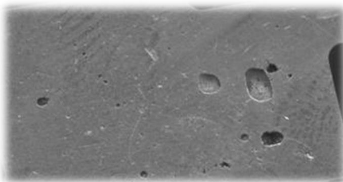
Figure I.17 : Défauts dus au gaz (soufflure=défaut interne)
