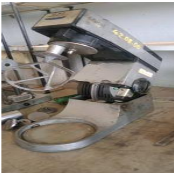
Figure III.1 : Mélangeur utilisé pour la préparation de nos mélanges
