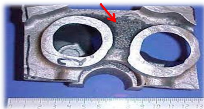
Figure I.22 : Pénétration d'expansion du métal
