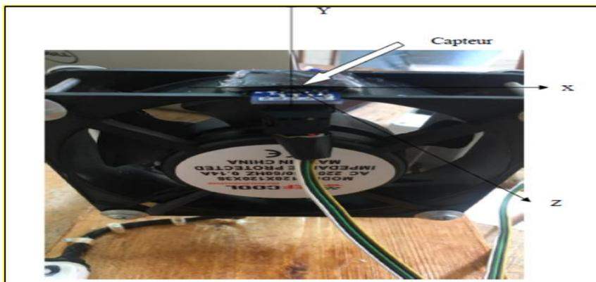
Figure 3.18: Montage et localisation du capteur ADXL [17]
