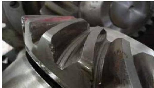
Figure 2.6 : défaut d'engrenage. [6]
