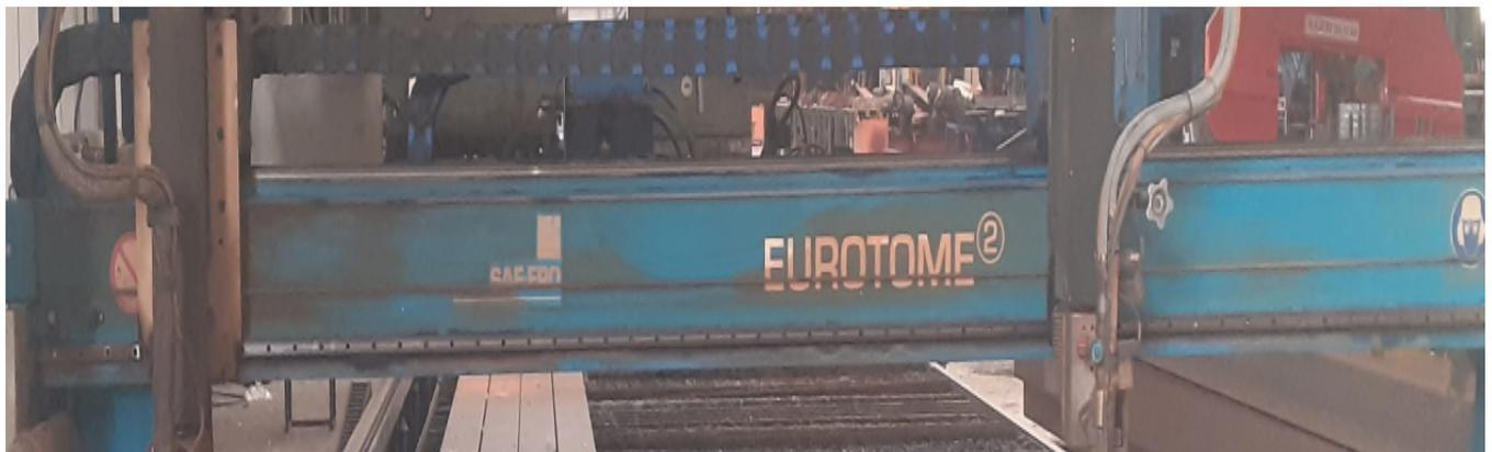
**Figure 3.17-La poutre Guidage transversal[10]**
