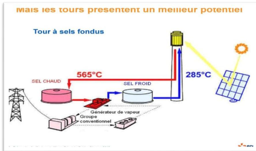
Figure I-4 : principe de la solaire thermodynamique [10]
