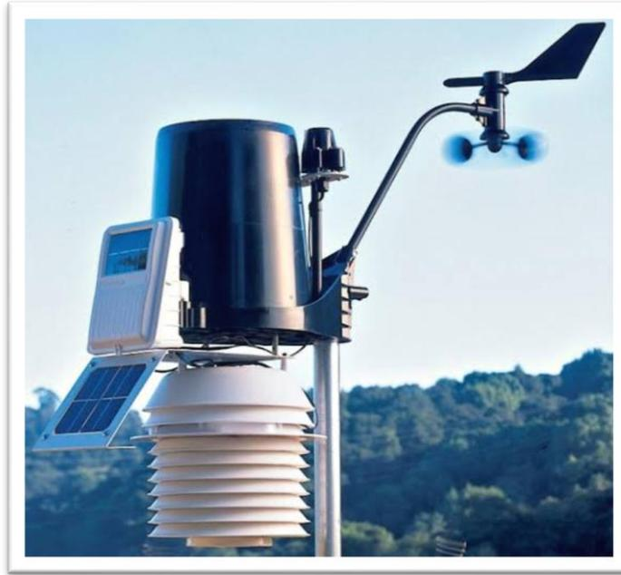
Figure II-27 : Anémomètre et girouette [57]
