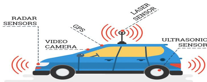
**Figure I. 3** Une voiture autonome [6].
