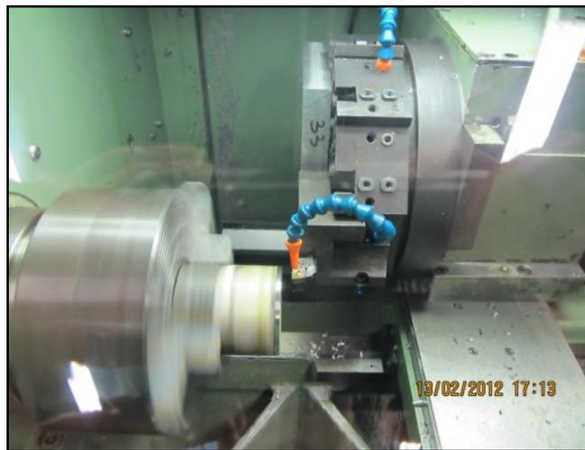
**Figure II. 5** Dispositif expérimental de la coupe orthogonale en tournage[20].
