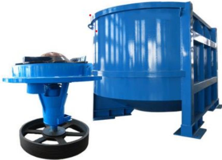
**Figure I.10** : Machine pulper recyclé le stock de papier [10]
