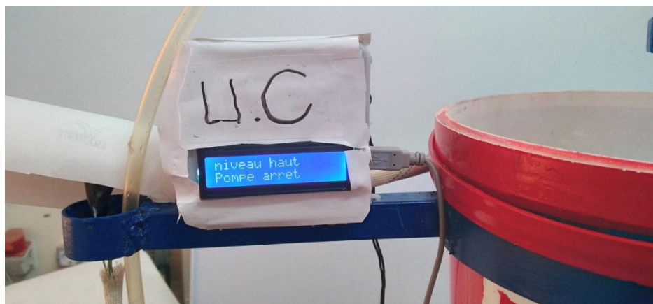
Figure 3.20 : Cas niveau d'eau haut (pompe arrêt)
