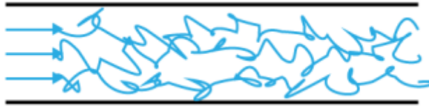
Figure 2.7 : Filet du colorant éclaté indiquant le régime turbulent.
