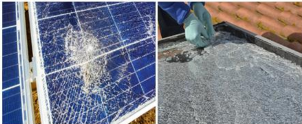
Figure IV.25 : Changement d’un verre de panneau solaire [47].
