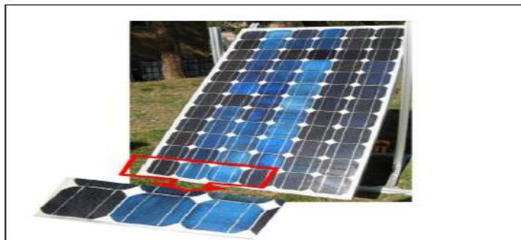
Figure III.6 : défaut de revêtement anti –reflet.
