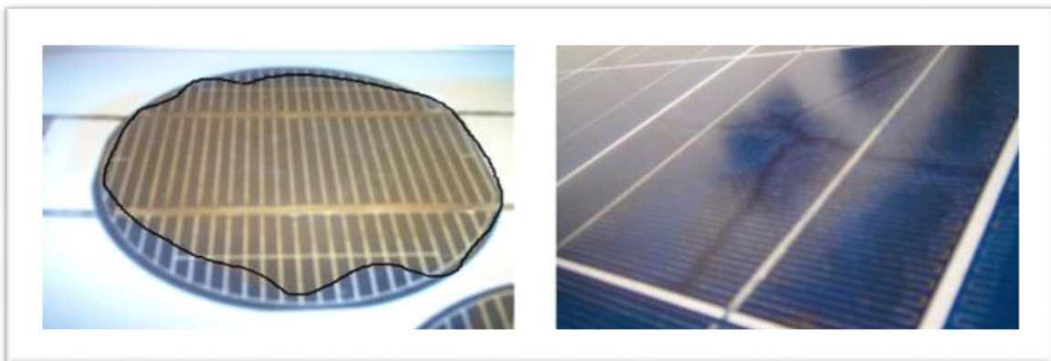
Figure III.2 : Modules photovoltaïques avec des cellules décolorées.
