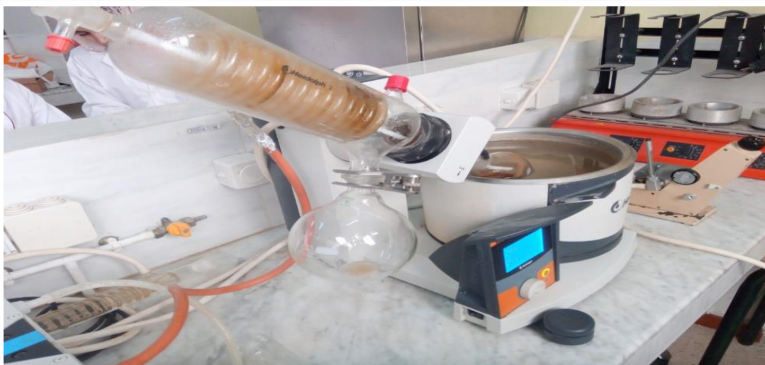
Figure 8 : Hydrodistillation par rota-vapeur.
