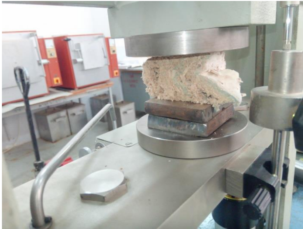
Figure 31 : Essai de la compression sur le produit final
