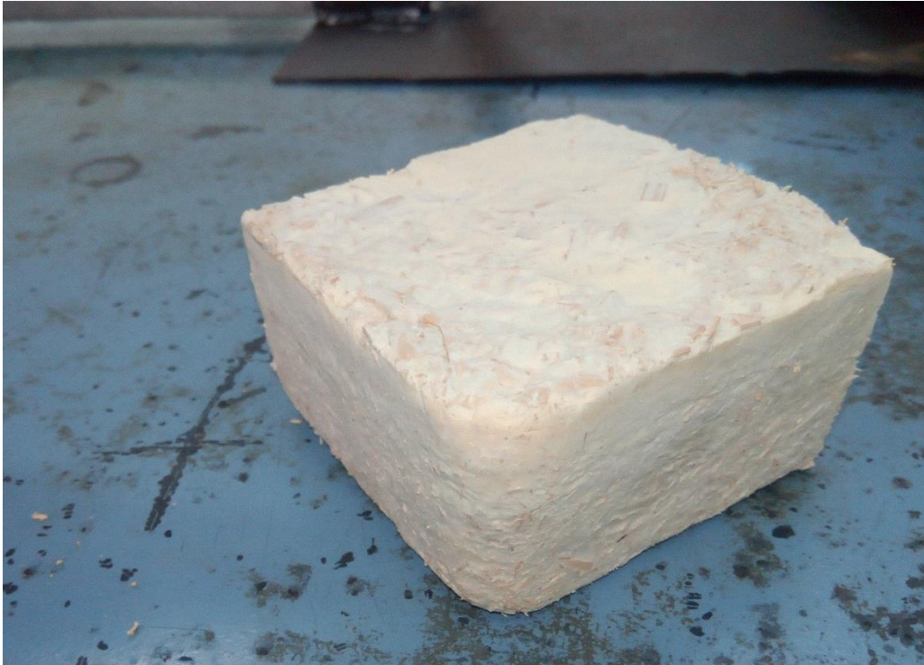
Figure 27 : Prototype KAM08-11 du bioemballage fait à partir de mycélium
