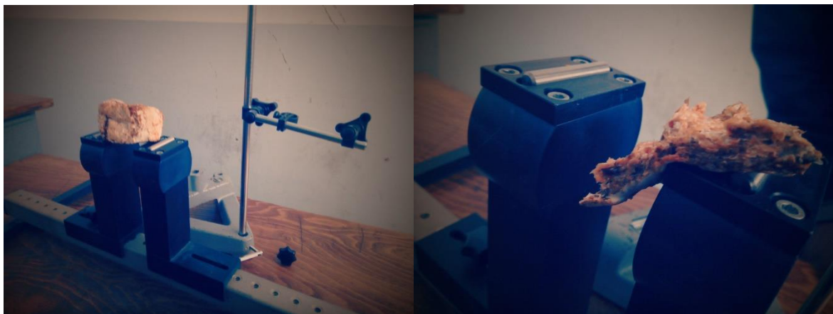
Figure 32 : Rupture du bioproduit lors du test de la flexion à trois points.
