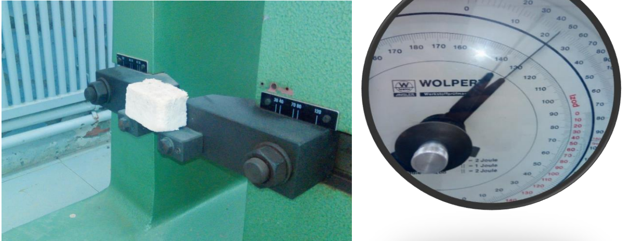
Figure 29 : Essai de la méthode de Charpy sur le produit final
