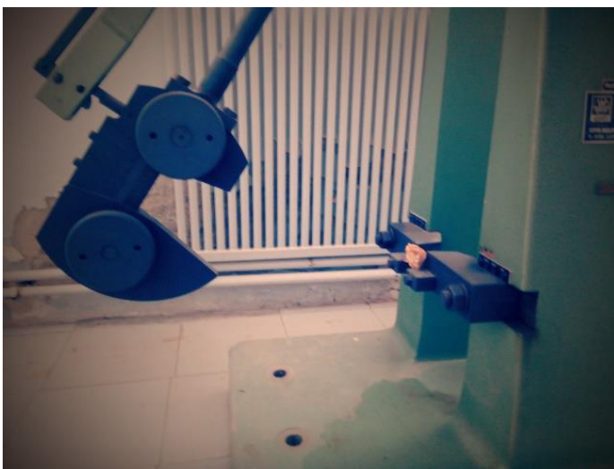
Figure 28 : Résultante de la force appliquée sur le bioproduit par méthode de Charpy
