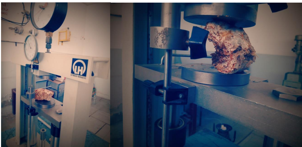
Figure 30 : Fléchure du bioproduit lors du test de compression.
