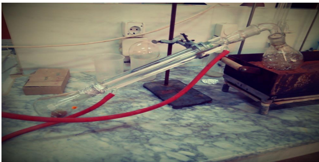
Figure 9 : Hydrodistillation par bain de sable
