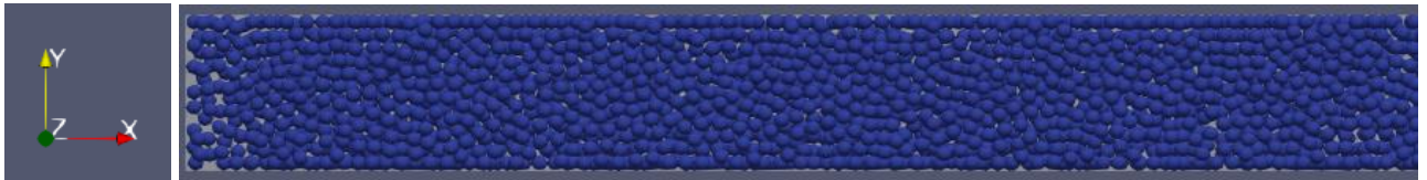
Figure 3-26: Répartition des grains pour (3*D) et vitesse (0.1cm/s)
