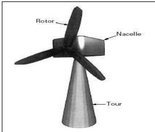
Figure II .10 : Composantes d'une éolienne
