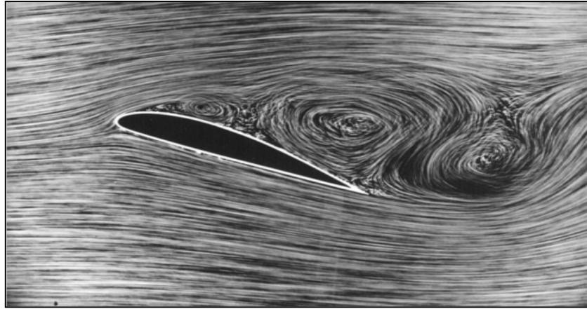
Figure 2.26: Profil d'aile en soufflerie en situation de décrochage les filets d'air se sont décollés de l'extrados [67].
