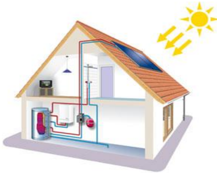
Figure I.1.3. Exemple de chauffage solaire. [5]
