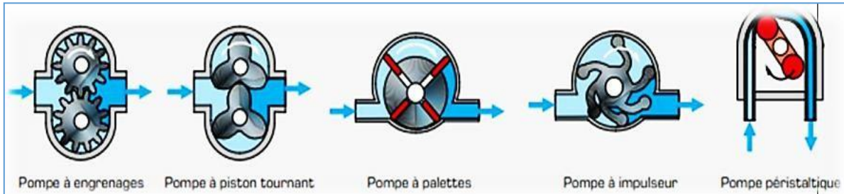
Fig. III-4 : Fonctionnement de quelques types de pompe volumétrique.
