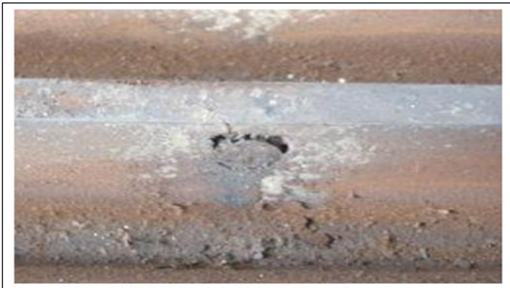
Fig. II-17 : Défaut d'inclusion de scories
