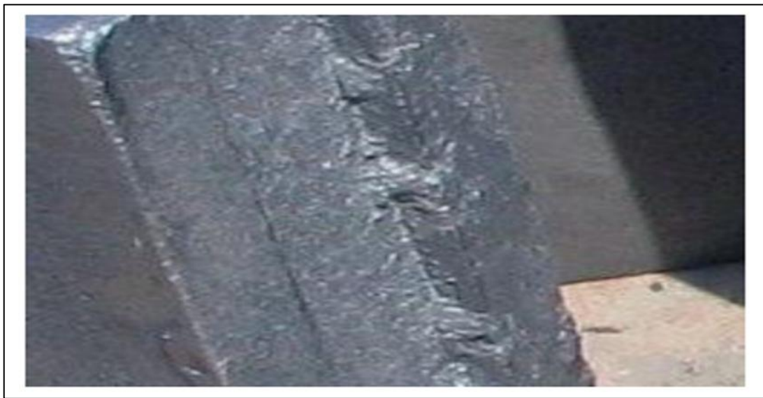
Fig. II-3 : Défaut de combustion du sable
