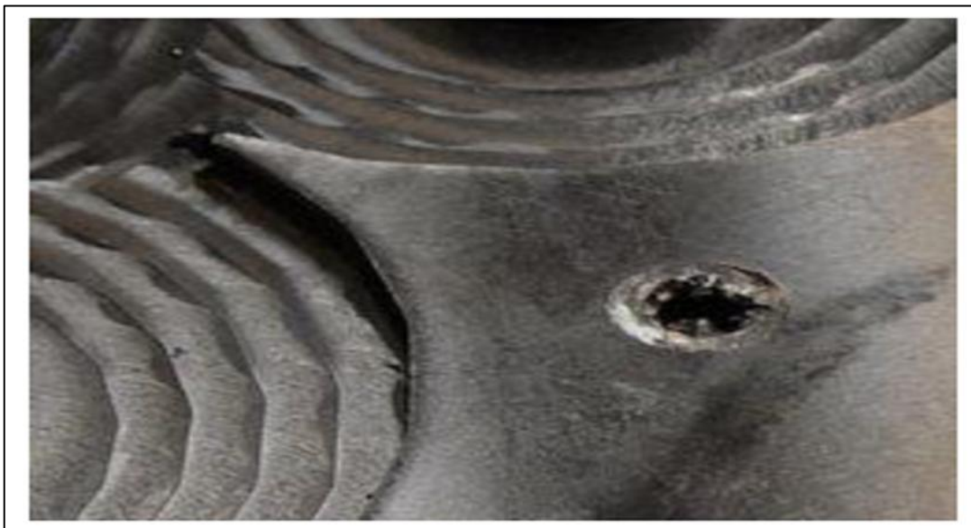
Fig. II-21 : Défaut de dureté inégale
