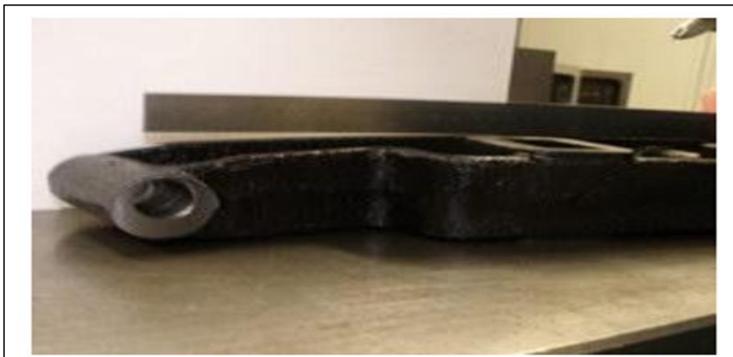
Fig. II-23 : Problème de déformation
