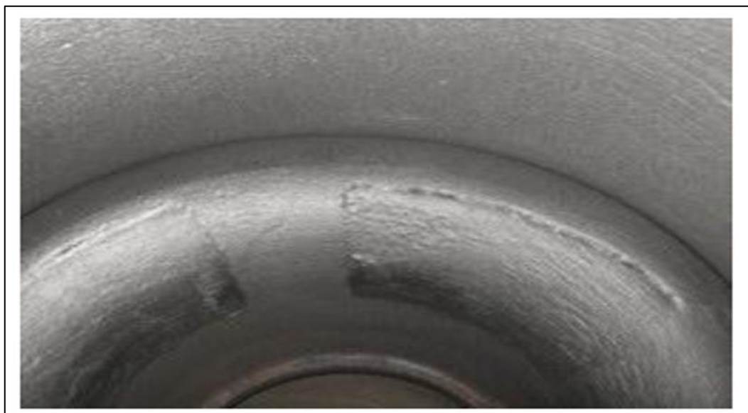
Fig. II-25 : Marques dues au manque de chauffage
