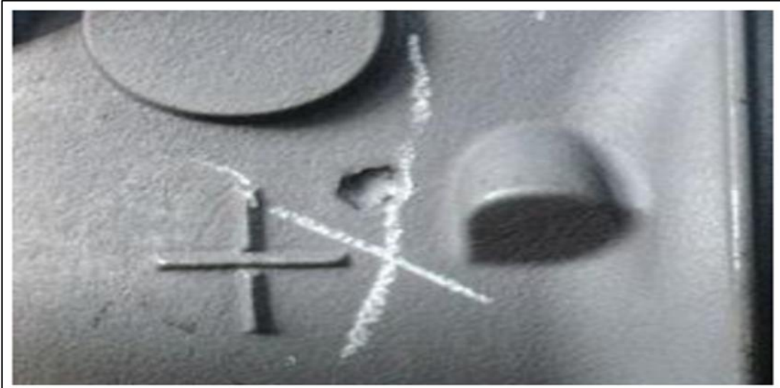
Fig. II-22 : Défaut de chute de sable
