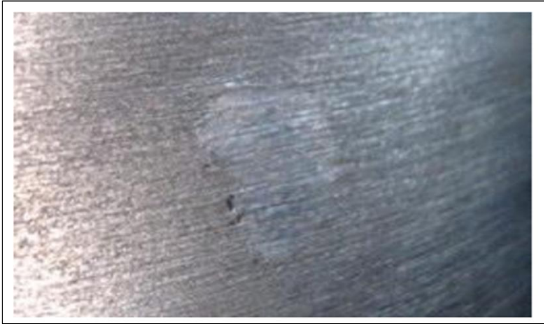
Fig. II-24 : Marques de réparation à la soudure
