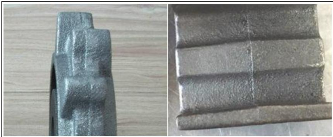
Fig. II-15 : Défaut de décalage ou désaxage
