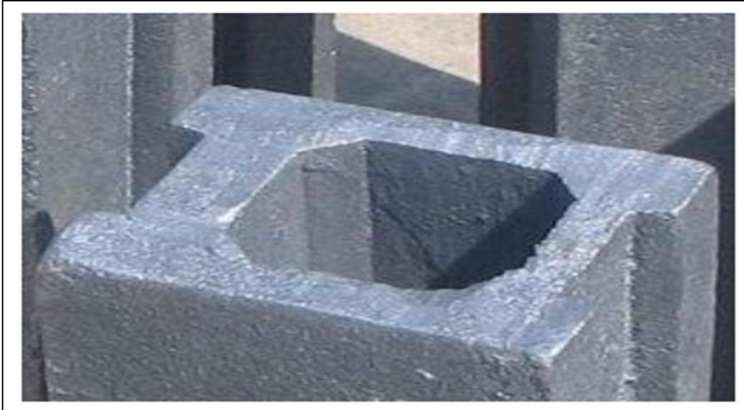
Fig. II-18 : Excroissances de métal à la surface des pièces
