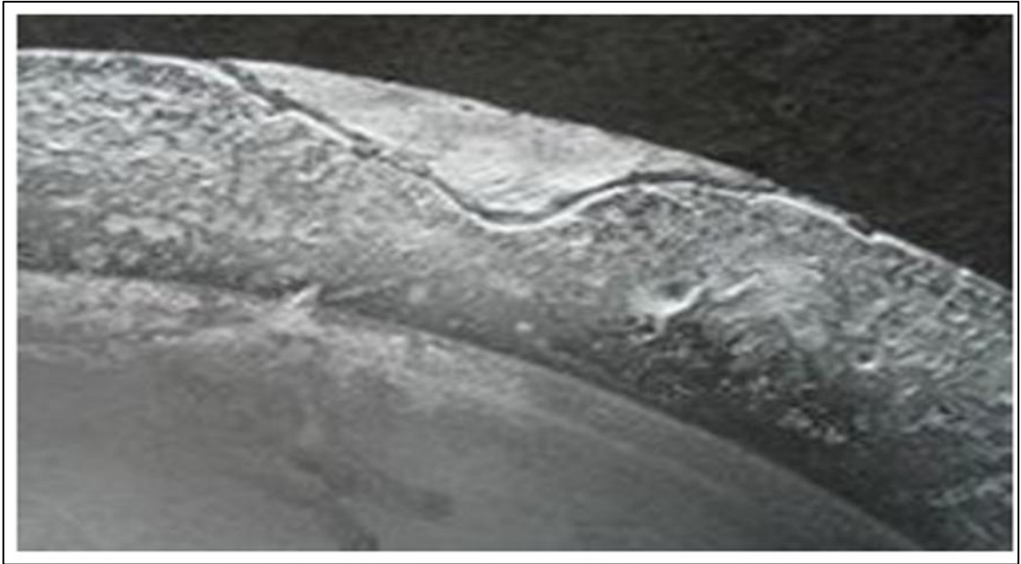
Fig. II-6 : Défaut de recouvrement a froid
