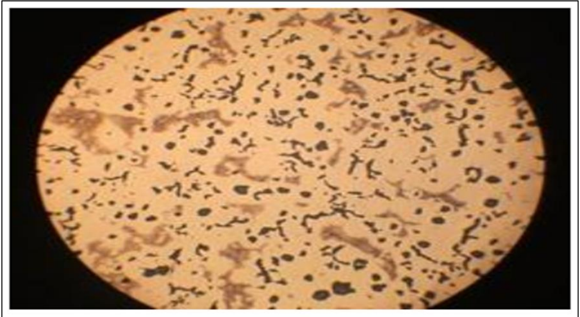
Fig. II-20 : Défaut de nodulation anormal
