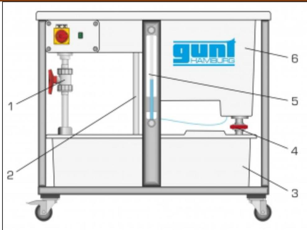
**Figure. III-2 :** Description du module de base «HM150 ».
